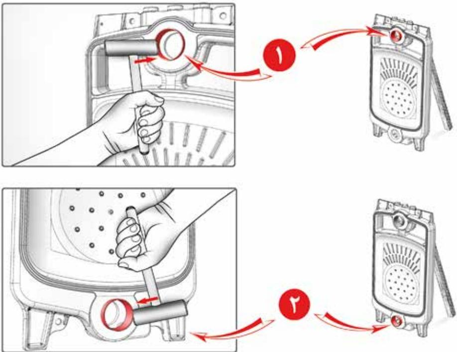
۵ - در صورت عدم استفاده از خمیر دیگ موجود در جعبه تحویلی از کارخانه ، روی شیارهای ریخته گری شده پره عقب دیگ چسب بمالید و سپس نخ نسوز را با چکش لاستیکی در شیار پره عقب جای گذاری نمائید .
