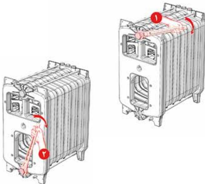
۱۳ - درب های بالا و پائین و دریچه بازدید شعله را به روش نشان داده شده روی دیگ مونتاژ نمائید. (به یاد داشته باشید که قبل از نصب درب نخ نسوز را در شیار درب نصب نمایید)
