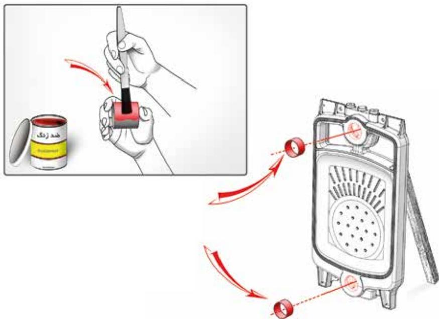
تذکر : توجه فرمائید در صورتیکه بوش ها درست جا نیفتند و یا کج در محل قرار گیرند هنگام مونتاژ ایجاد مشکل می کنند و سبب پیدا شدن درز و نشت آب از دیگ می شوند . برای اطمینان از آب بندی بوش ها می توانید وسط بوش را ضد زنگ و چند لایه نوار تفلون ببندید که کاملاً درز بوش و نافی پره آب بندی گردد . دقت فرمائید بوش مربوط به دیگ تهیه گردد . بوش های متفرقه بدلیل زاویه اشتباه در مقایسه با زاویه نافی دیگ سطح تماس کافی آبیندی نداشته و ایجاد نشتی و مشکلات زیادی برای دیگ می نماید.
