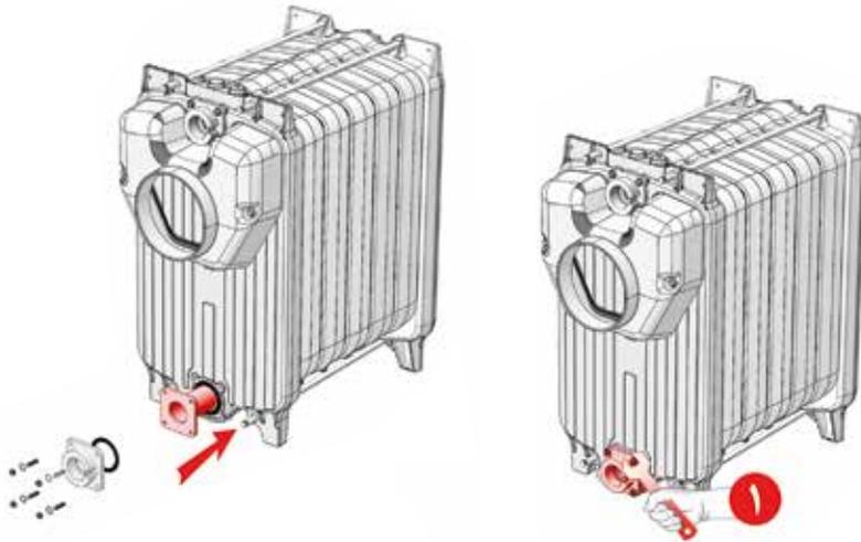
۱۶ - پس از اتمام نصب، دیگ را مطابق روال گفته شده تست نمایید تا اطمینان یابید که دیگ در حین بهره برداری دچار نشتی آب نگردد سپس از خمیر دیگ جهت دودبند نمودن دیگ استفاده نمایید.
